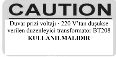
Dikkat, eğer voltaj 220 V ac'den düşükse düzenleyici transformatör kullanınız.
